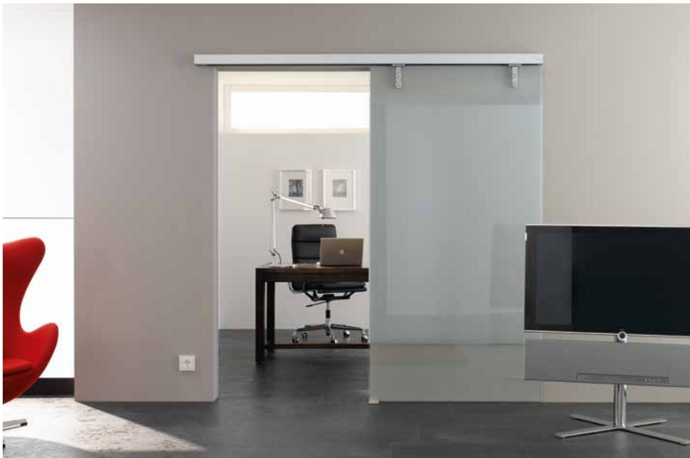
Der automatische Schiebetürantrieb **CS 80 MAGNEO** wird allein von der magnetischen und damit berührungslosen Schubwelle eines Linearmotors bewegt. Diese Technik ermöglicht den nahezu geräuschlosen Antrieb. Die kombinierte Einheit aus Linearmotor und Laufschiene erleichtert die Installation vor Ort und erlaubt den Einbau des Antriebes in die Eclisse Schiebetürkästen nach Fertigstellung der Wände im Trocken- oder Massivwandbau.
